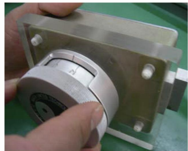
⑥ 闭锁：锁处于开启状态，顺时针转动拨码盘，让M点超越标识线后锁舌伸出锁体，锁即关闭。
