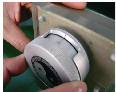
③ 逆时针转动拨码盘让M点回到标识线（以手感为准）
