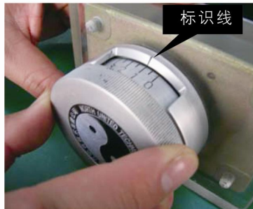
② 顺时针转动拨码盘，让第一位密码数值对准标识线。
